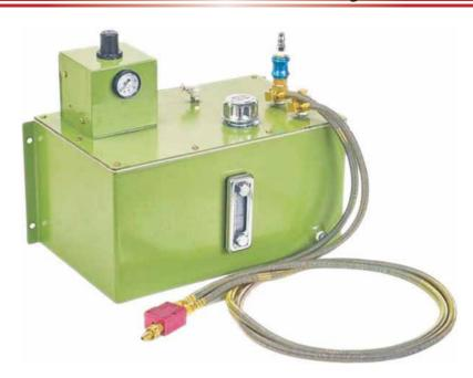
TC1500噴霧冷却單位適合在最短時間迅速對多數一般機械工具賦予一個可加工深孔的能力;它的特點是便於移動及携帶且只要連接到工廠中的空氣壓縮機上的氣壓供應。TC1500系統運作是將氣流推動霧化泵浦單位中,再加壓到乳化液油上,再經由壓縮空氣霧化後送到可調節壓力的接頭裏,進入刀座後再通過鑽頭或槍鑽。它最主要的功能是藉由乳化液霧化後,冷却刀具切削時刀口所產生的熱能,一方面冷却刀具也同時將水蒸發,而留下潤滑油來潤滑刀具口,且空氣的壓力也將同時排出加工時所產生的加工物。
