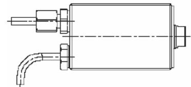
为此,粉末冶金类透气过滤器需通过嵌入式螺纹接套装配来更换,见分类样本J7.400,或相应的旋入螺口连接,见分类F9.300。
