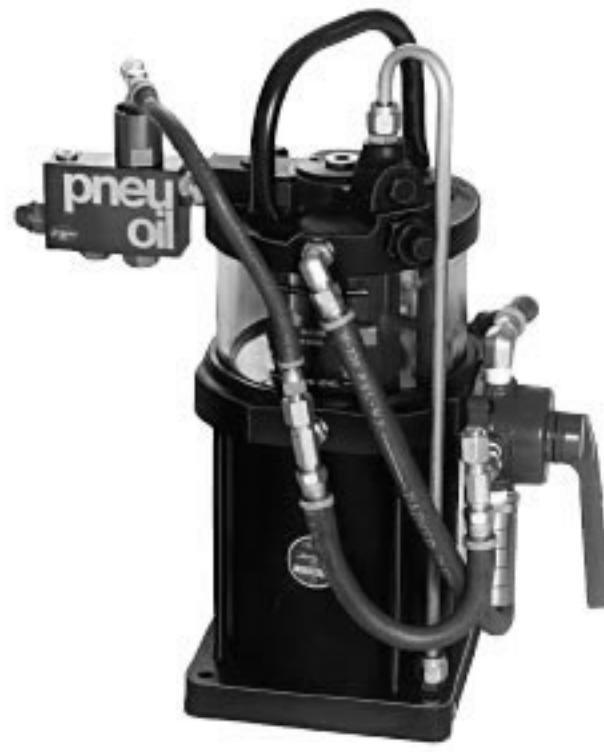
本公司预充气套件为一个可自由移动的动力源。驱动和控制液压夹具的所有东西都包含在此产品中。将工厂的气管连接到过滤器调整器上，将夹具连接到液压软管上。自排气特征及液压快速断开器使该设备成为车间和生产线上的理想动力源。
